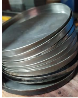
Figure 3.19: metal pans to pour binder
