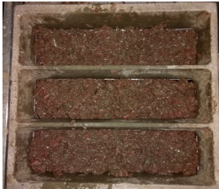
(d) Prism moulds after filling and compacting first layer
